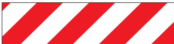
Das Breitenverhältnis der gelben zu den schwarzen Streifen beträgt 1 : 1 bis 1,5 : 1. Die Streifenbreite der schwarzen Streifen richtet sich nach den Maßen des Objektes und ist so auszuführen, dass der Anteil der Sicherheitsfarbe „Gelb“ mindestens 50% der Gesamtfläche beträgt. Die Streifen sind in einem Neigungswinkel von etwa 45° anzuordnen. Rot-weiße Streifen sind sinngemäß auszuführen.
